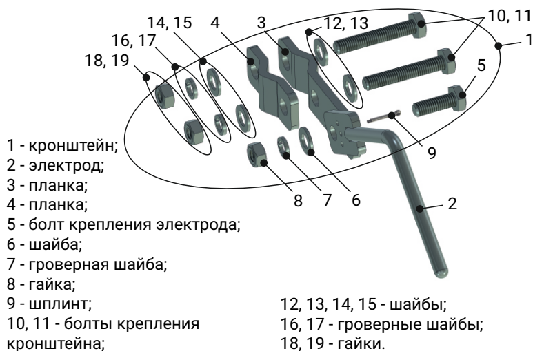
Рисунок 2 - Внешний вид кронштейна и электрода мультикамерного разрядника РМКЭ-20-IV-УХЛ1
