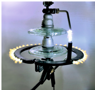
Рисунок 12 - Фотография разрядника РМКЭ-20-IV-УХЛ1 при срабатывании
